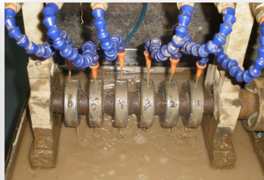
轴承泥浆防水测试台架
