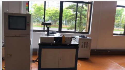
BLT-S2D滚动轴承污染环 境下高速耐磨性能试验机
