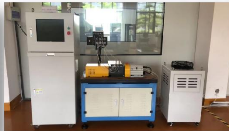
BLT-XS1微小型滚动轴承10万 转超高速高温寿命试验机
