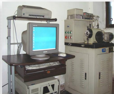
BGT-1A型 密封轴承漏脂温 升防尘性能试验机
