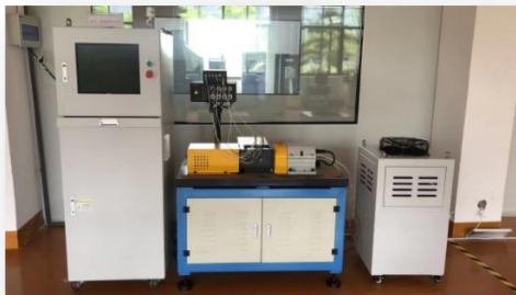
BLT-S2C滚动轴承高温高速 疲劳寿命试验机
